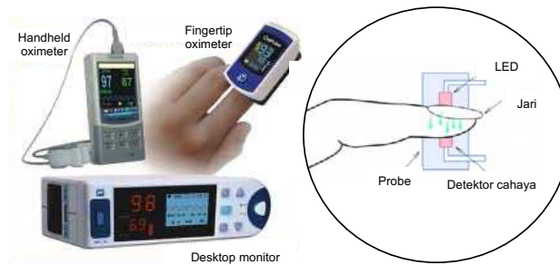
Gambar 3.13. Pulse oximeter dan skema sistem deteksi
